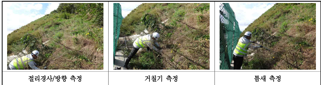
【그림 36.3.5】 불연속면 측정 현황
